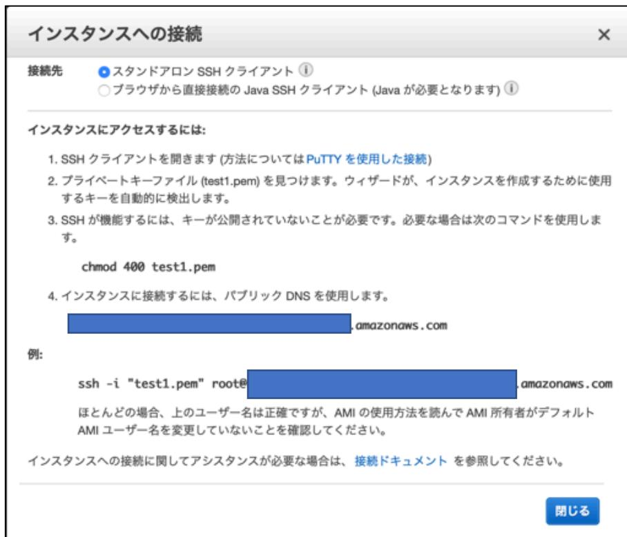
接続前に、クライアント側で作業用ディレクトリを作成して、その下にキーペアのファイルを移動しておくとよいでしょう。
